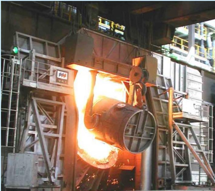
Abb.: LD-Kompaktstahlwerk der VOEST-ALPINE STAHL DONAWITZ
