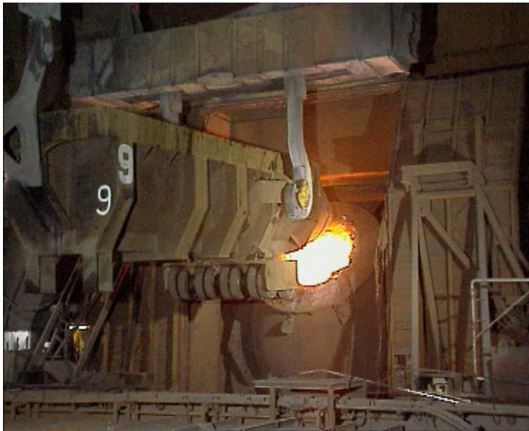
Abb.: Schrottchargieren („Einsetzen“ von Schrott)
