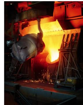
Abb.: Chargieren von flüssigem Roheisen
