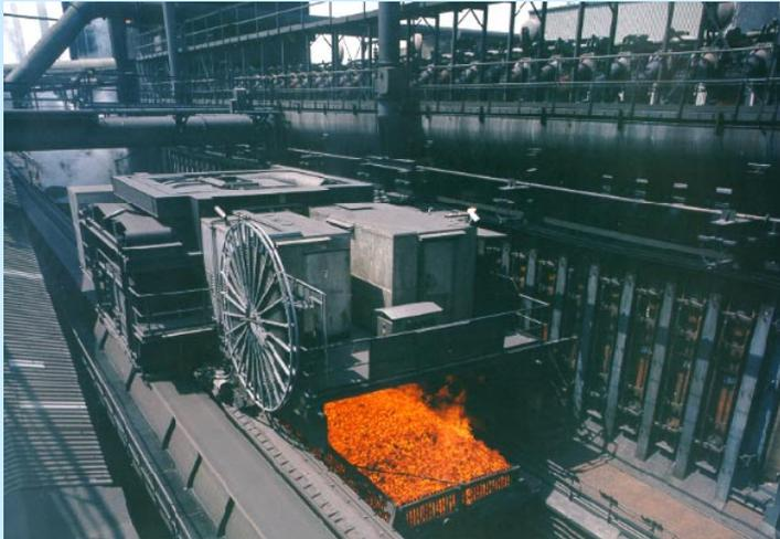
Abb.: Koksüberleitmaschine mit Absaugung
